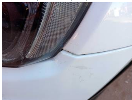
Bouclier avant (Défaut aspect)
